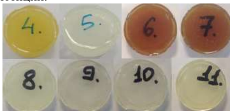
Рисунок 1. Полимеры, соотношение ЭД-20 к отвердителю 10:1
